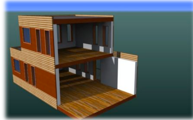
Sous ensembles montés sur chantier
