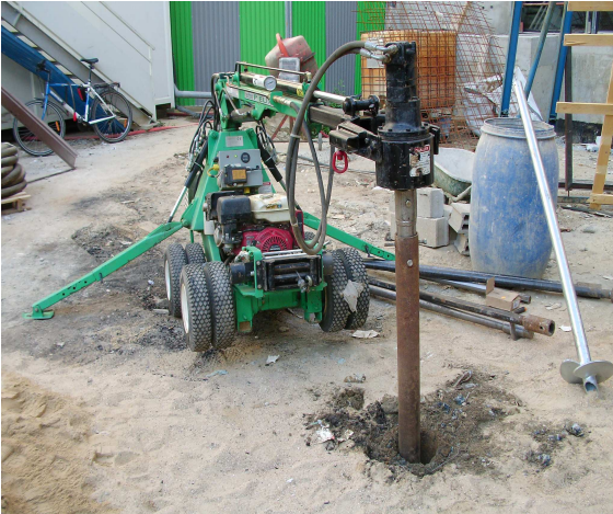
Machine utilisée pour la mise en place des pieux
